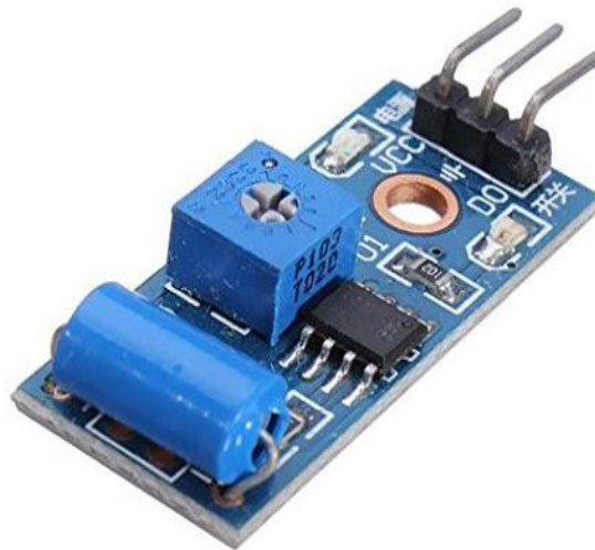
Fig: Vibration sensor
